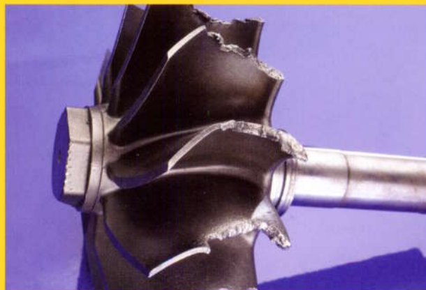
7.12 Impact d'un objet étranger sur l'arbre de turbine
