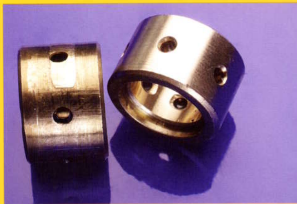
7.2 Pailier endommagé à côté d'un pailier neuf
