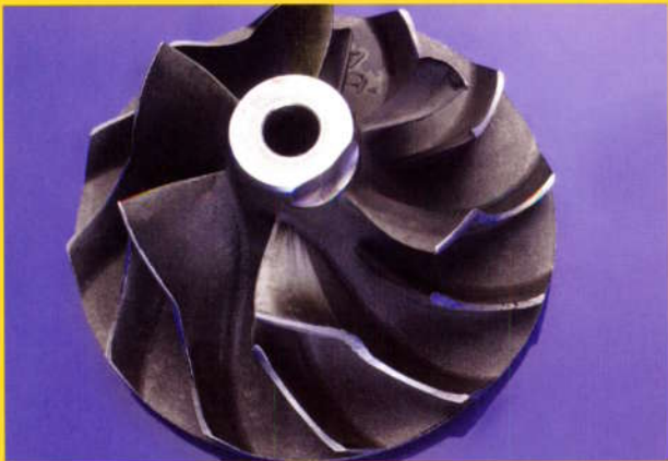
7.8 Frottement de la roue de compresseur.
