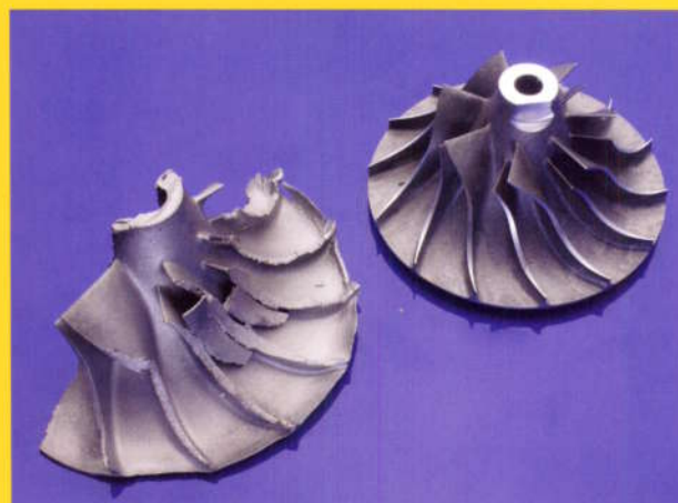
7.25 Roue de compresseur cassée
