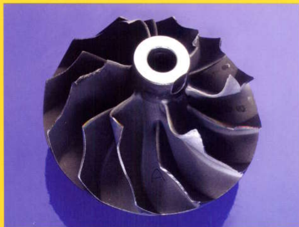
7.24 Roue de compresseur endommagée
