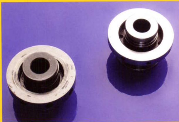
7.6 Porte-segment endommagé à côté d'un porte-segment neuf
