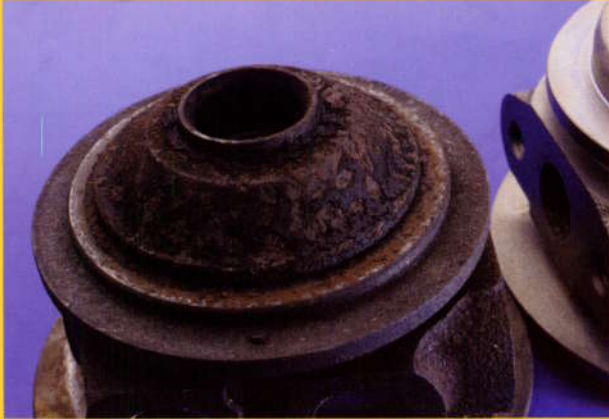
7.19 Huile lubrifiante carbonisée dans le carter de palier
