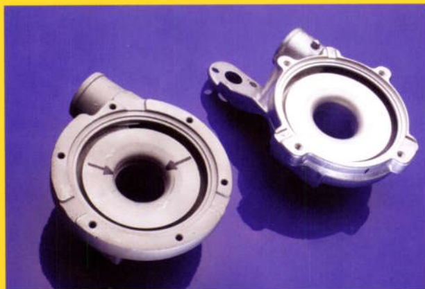
7.9 Carter compresseur endommagé à côté d'un carter neuf
