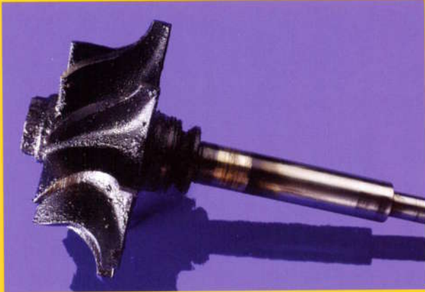
7.5 Dépôt de cuivre sur l'arbre de turbine
