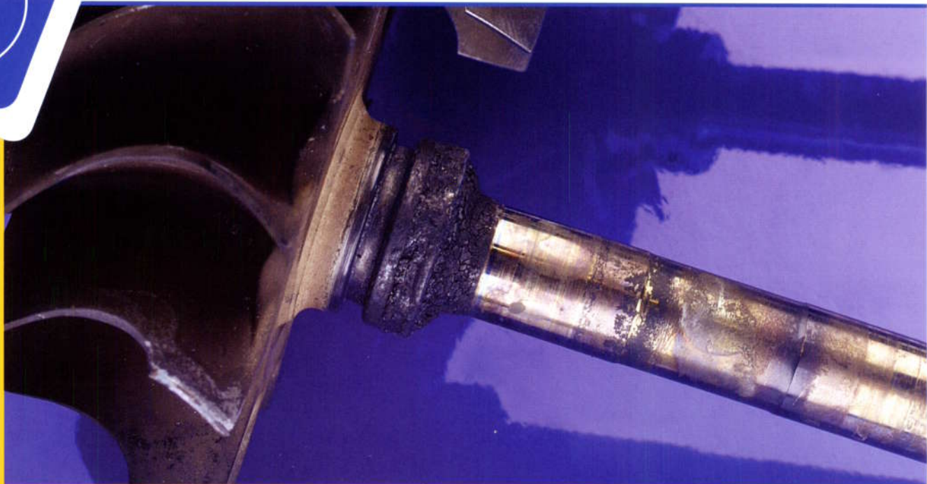
7.22 Usure de la gorge de segment de l'arbre de turbine
