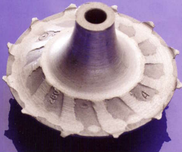
7.14 Impact d'un objet étranger sur la roue de compresseur
