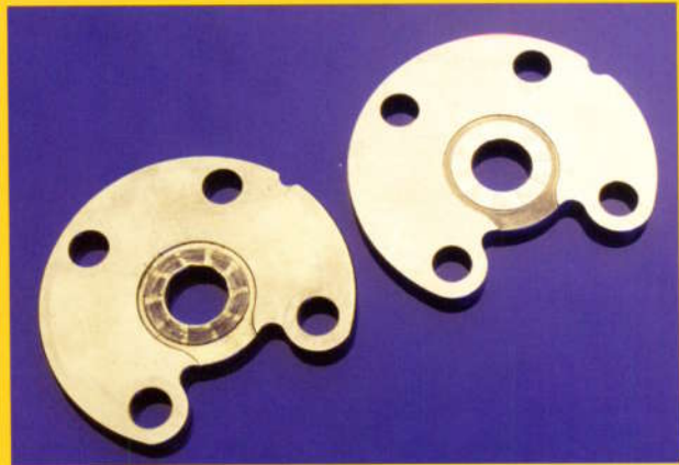
7.7 Palier axial endommagé à côté d'un palier axial neuf
