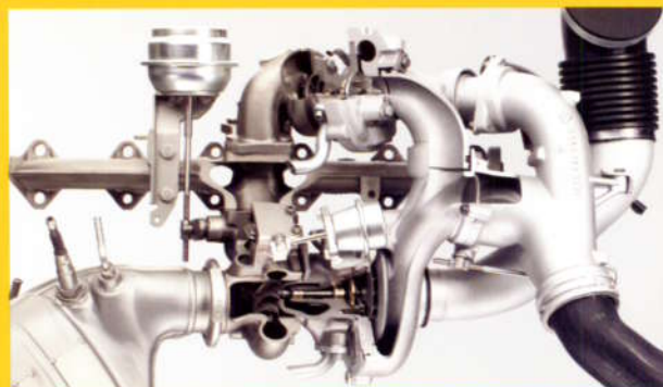
5.1 Le moteur diesel BMW Variable Twin Turbo
